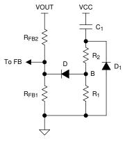
Figure 7-3. Soft-Start Circuit
