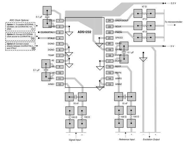
Figure 11-1. ADS1232 Layout Example
