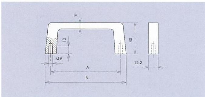
Einschließlich Schrauben DIN 84-M5 x 12 und Scheiben DIN 125.
