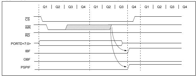
FIGURE 10-4: PARALLEL SLAVE PORT READ WAVEFORMS
