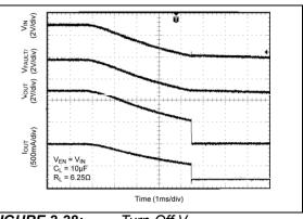
**FIGURE 2-28:** Turn-Off V<sub>IN</sub>.
