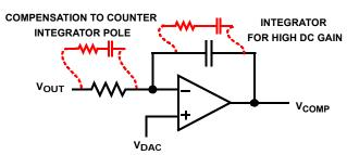
FIGURE 12. INTEGRATOR ERROR-AMPLIFIER CONFIGURATION
