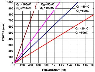
FIGURE 20. POWER DISSIPATION vs FREQUENCY
