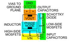
FIGURE 21. TYPICAL POWER COMPONENT PLACEMENT
