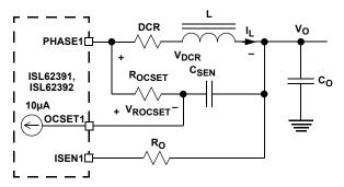
FIGURE 26. OVERCURRENT-SET CIRCUIT
