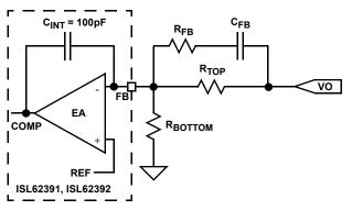
FIGURE 27. COMPENSATION REFERENCE CIRCUIT
