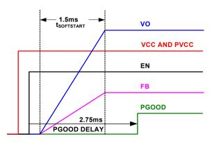
FIGURE 24. SOFT-START SEQUENCE FOR ONE SMPS
