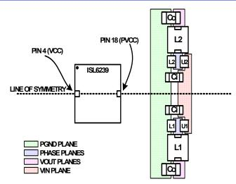
FIGURE 30. SYMMETRIC LAYOUT GUIDE
